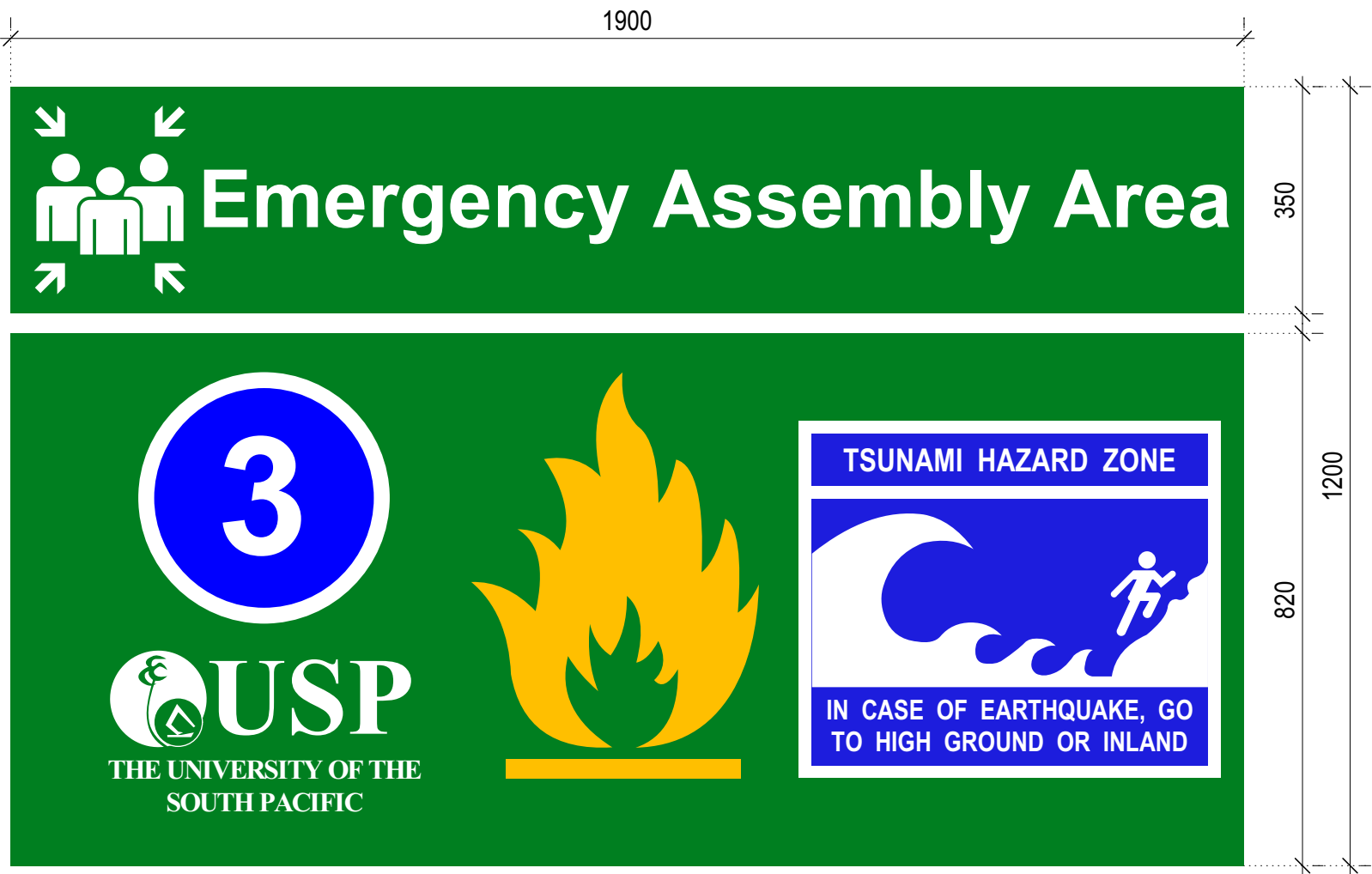
1 SIGNAGE ELEVATION Scale: 1:10
